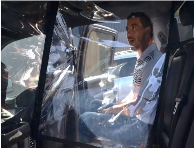
L'entreprise de Sudbury Rezplast a mis au point un système en plastique et en velcro pour séparer les travailleurs qui doivent monter dans le même véhicule. [Cliquez ici pour en savoir plus.](#)
